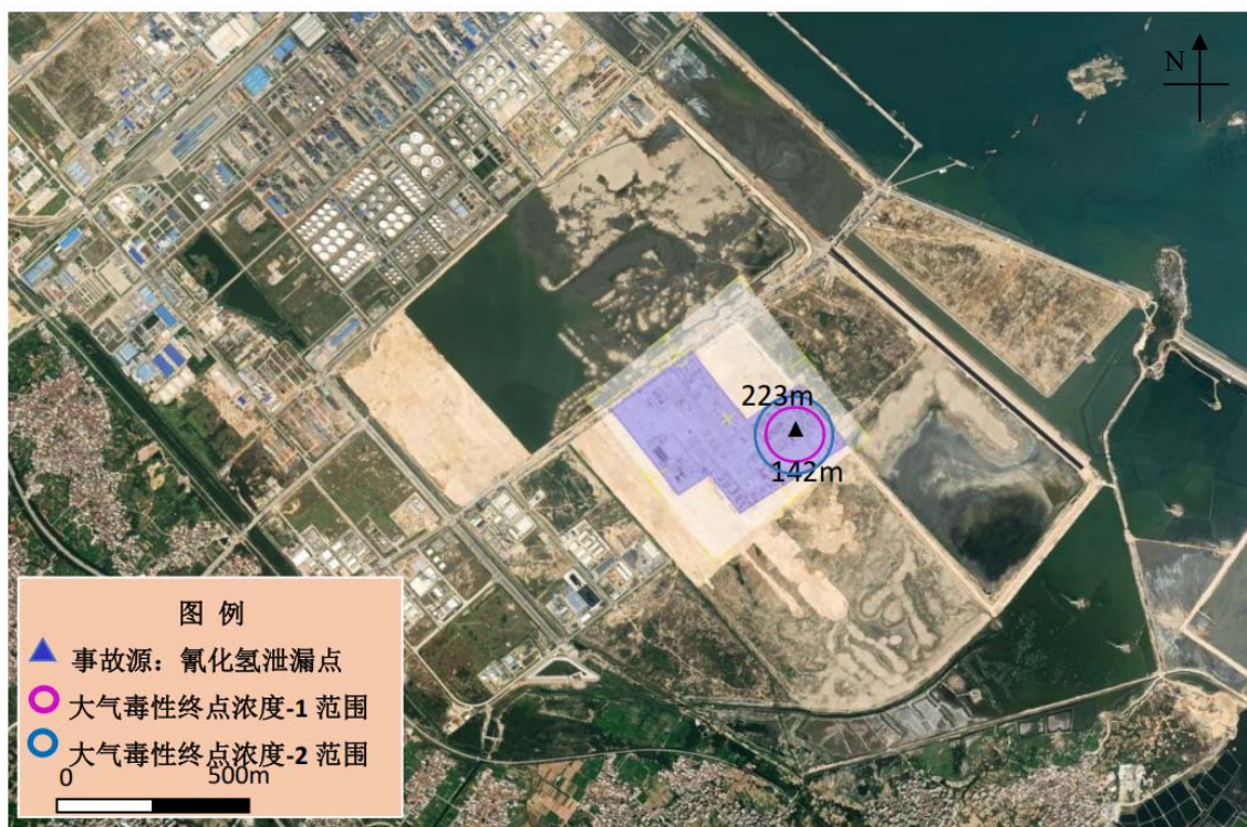
图 6.5-16 氰化氢泄漏事故预测后果范围图（最常见气象条件）
