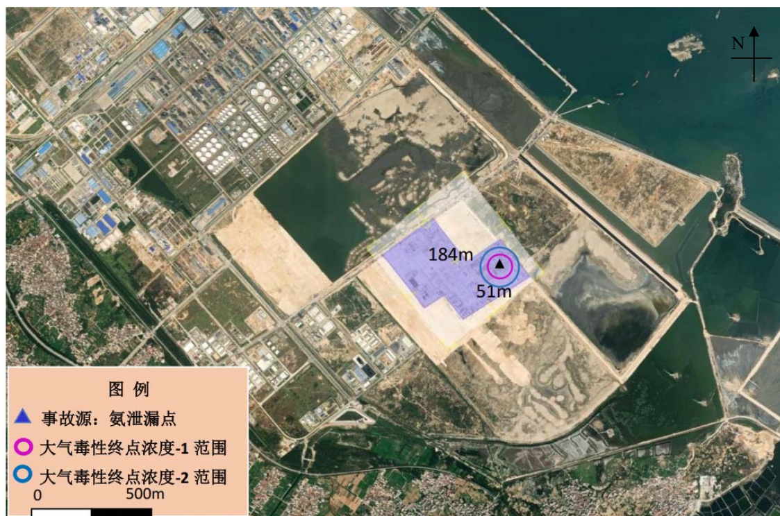
图 6.5-10 氨气泄漏事故预测后果范围图（最不利气象条件）
