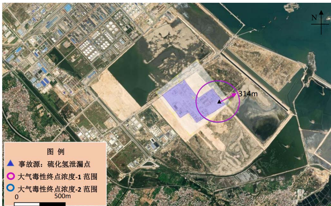
图 6.5-4 硫化氢泄漏事故预测后果范围图（最常见气象条件）
